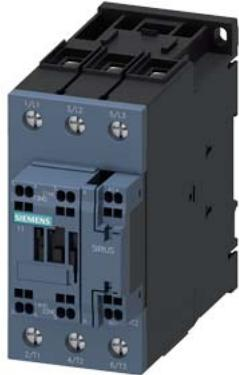
contattore ferroviario, AC-3e/AC-3, 80 A, 37 kW / 400 V, a 3 poli, DC 110 V, 0,7-1,25\* Uc, comando elettronico, con varistore integrato, contatti ausiliari: 1 NO + 1 NC, circuito principale: morsetti a vite, circuito di comando e circuito ausiliario: morsetti a molla, grandezza costruttiva: S2
