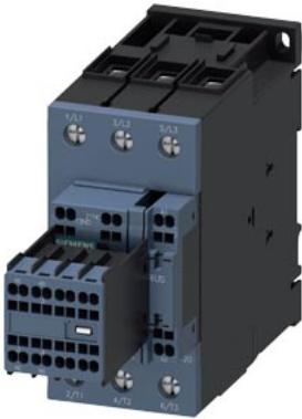
contattore di potenza, AC-3e/AC-3, 65 A, 30 kW / 400 V, a 3 poli, AC/DC 48...80 V, 50/60 Hz, con varistore integrato, contatti ausiliari: 2 NO + 2 NC, circuito principale: morsetti a vite, circuito di comando e circuito ausiliario: morsetti a molla, grandezza costruttiva: S2, blocchetto di contatti ausiliari rimovibile
