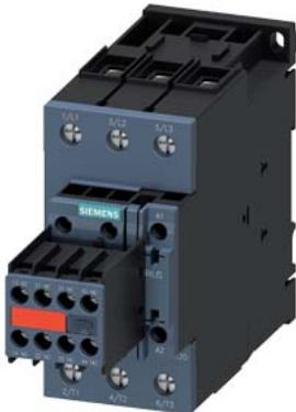
contattore di potenza, AC-3e/AC-3, 51 A, 22 kW / 400 V, a 3 poli, AC 110 V, 50 Hz / 120 V, 60 Hz, contatti ausiliari: 2 NO + 2 NC, morsetti a vite, grandezza costruttiva: S2, blocchetto di contatti ausiliari non rimovibile
