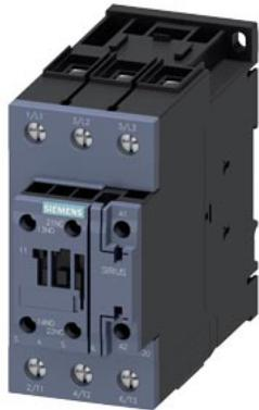
contattore di potenza, AC-3e/AC-3, 41 A, 18,5 kW / 400 V, a 3 poli, DC 24 V, 0,8-1,2\* Uc, con varistore integrato, contatti ausiliari: 1 NO + 1 NC, morsetti a vite, grandezza costruttiva: S2, adatto per uscite PLC, posizione di montaggio verticale
