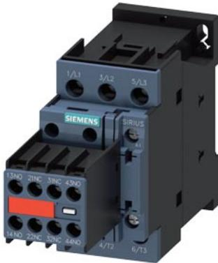
contattore di potenza, AC-3e/AC-3, 38 A, 18,5 kW / 400 V, a 3 poli, AC 230 V, 50/60 Hz, contatti ausiliari: 2 NO + 2 NC, morsetti a vite, grandezza costruttiva: S0, blocchetto di contatti ausiliari non rimovibile, senza limitatore di sovratensione retrofittabile
