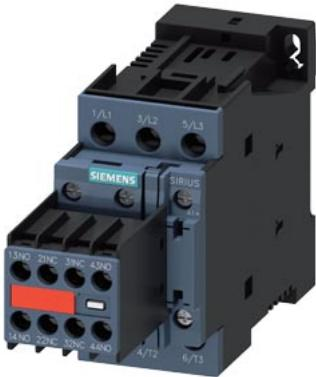
contattore di potenza, AC-3e/AC-3, 32 A, 15 kW / 400 V, a 3 poli, DC 24 V, contatti ausiliari: 2 NO + 2 NC, morsetti a vite, grandezza costruttiva: S0, blocchetto di contatti ausiliari non rimovibile, senza limitatore di sovratensione retrofittabile
