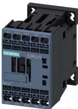
contattore di potenza, AC-3e/AC-3, 12 A, 5,5 kW / 400 V, a 3 poli, DC 24 V, 0,85-1,85\* Uc, con diodo integrato, contatti ausiliari: 1 NO, morsetti a molla, grandezza costruttiva: S00, non ampliabile con blocchetto di contatti ausiliari
