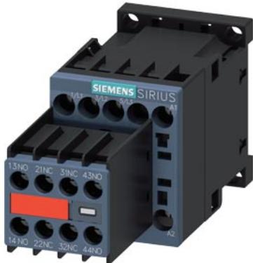
contattore di potenza, AC-3e/AC-3, 9 A, 4 kW / 400 V, a 3 poli, AC 110 V, 50 Hz / 120 V, 60 Hz, contatti ausiliari: 2 NO + 2 NC, morsetti a vite, grandezza costruttiva: S00, blocchetto di contatti ausiliari non rimovibile
