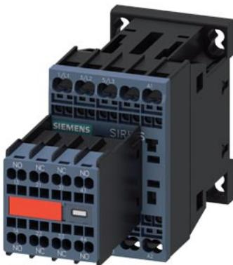
contattore di potenza, AC-3e/AC-3, 7 A, 3 kW / 400 V, a 3 poli, DC 24 V, contatti ausiliari: 2 NO + 2 NC, morsetti a molla, grandezza costruttiva: S00, blocchetto di contatti ausiliari non rimovibile
