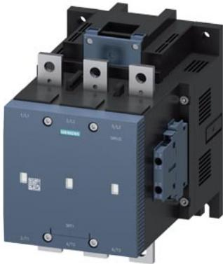
contattore sottovuoto, AC-3 400 A, 200 kW / 400 V AC (50...60 Hz) / comando in DC AC/DC 575-600 V contatti ausiliari 2 NO + 2 NC a 3 poli, grandezza costruttiva S12 attacchi a sbarra azionamento: convenzionale
