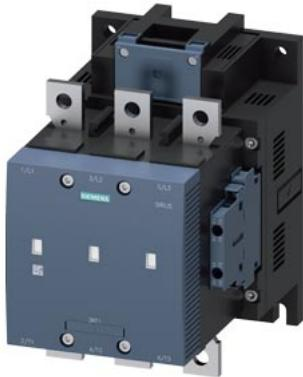
contattore sottovuoto, AC-3 265 A, 132 kW / 400 V AC (50...60 Hz) / comando in DC AC/DC 575-600 V contatti ausiliari 2 NO + 2 NC a 3 poli, grandezza costruttiva S10 attacchi a sbarra azionamento: convenzionale
