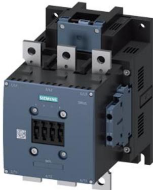
contattore di potenza, AC-3e/AC-3 300 A, 160 kW / 400 V AC (50 ... 60 Hz) / DC Uc: 21 ... 27, 3 V ingresso PLC DC 24 V a 3 poli, contatti ausiliari 2 NO + 2 NC azionamento: elettronico circuito princ.: sbarra circuito di comando e circuito ausiliario: attacco a vite
