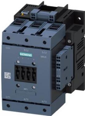
contattore di potenza, AC-3e/AC-3 115 A, 55 kW / 400 V, AC (50 ... 60 Hz) / DC Uc: 200 ... 277 V ingresso PLC DC 24 V a 3 poli, contatti ausiliari 2 NO + 2 NC azionamento: elettronico circuito princ.: morsetto serracavo circuito di comando e circuito ausiliario: morsetti a molla
