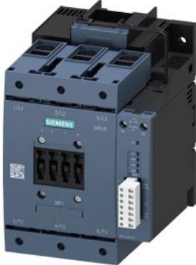
contattore di potenza, AC-3e/AC-3 115 A, 55 kW / 400 V, AC (50 ... 60 Hz) / DC Uc: 200 ... 277 V ingresso PLC DC 24 V a 3 poli, contatti ausiliari 1 NO + 1 NC azionamento: elettronico circuito princ.: morsetto serracavo circuito di comando e circuito ausiliario: attacco a vite , segnalazione di durata residua
