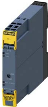
modulo ASIsafe SlimLine Compact SC17.5F digital safety 2F-DI, IP20 2 x ingressi per sensori meccanici morsetti a molla larghezza costruttiva 17,5 mm
