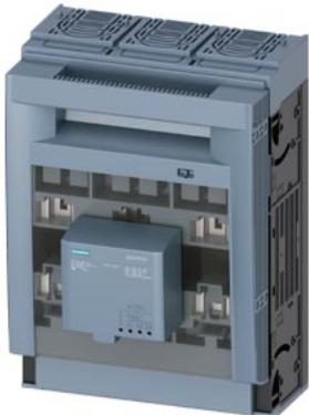
SENTRON, sezionatore sottocarico a fusibili 3NP1, a 3 poli, NH2, 400 A, per montaggio e installazione su piastra di montaggio, morsetto serracavo, controllo fusibili: elettronico EFM10, livello di copertura 70mm
