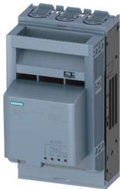
SENTRON, sezionatore sottocarico a fusibili 3NP1, a 3 poli, NH00, 160 A, per montaggio e installazione su piastra di montaggio, morsetto serracavo, controllo fusibili: elettronico EFM10, livello di copertura 45mm
