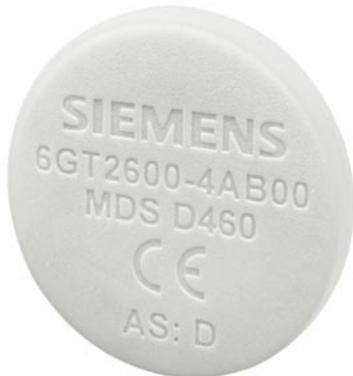
transponder MDS D460 per RF200/RF300 ISO/MOBY D pastiglia ISO 15693, tipo di chip FUJITSU MB89R118, 2000 byte FRAM memoria utente 16x 3 mm (DxA); min. quantità ordinabile 50 pezzi.
