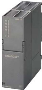
Compact Switch Module CSM 377 collegamento SIMATIC S7-300 e fino a 3 altri nodi su Industrial Ethernet con 10/100 Mbit/s switch unmanaged, 4 porte RJ45, ext. alimentazione di tensione DC 24 V diagnostica LED, unità S7-300, incl. manuale del prodotto elettron. su CD-ROM.
