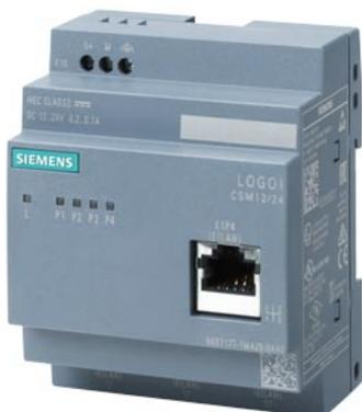
LOGO! CSM12/24 Compact Switch modulo collegamento di un'unità LOGO! (. .0BA7/...0BA8) e di fino a 3 ulteriori nodi a Industrial Ethernet con 10/100 Mbit/s switch unmanaged, 4 porte RJ45 1x porta frontale per la diagnostica DC alimentazione di tensione 12/24V diagnostica LED, configurazione LOGO!
