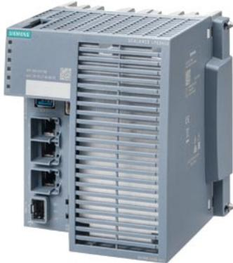
SCALANCE LPE9413 Ind. Edge Local Processing Engine; 64 bit ARMv8 (4 core); 4GB RAM; 40GB eMMC(pSLC); 3x RJ45 da 10/100/1000 Mbit/s; 1x 100/1000 Mbit/s SFP; comprende 1 porta Combo; 1x USB3.0; slot per CLP; LED di diagnostica; alimentazione di tensione ridondante; montaggio: guida DIN/profilata S7
