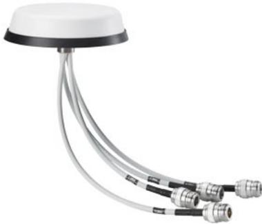
antenna ANT897-5PN per reti radiomobili 5G private e WLAN con 4 elementi di antenna; caratteristica omnidirezionale ; 2,3..7,2 GHz; guadagno di antenna: 4..6dBi, incl. 4x cavi con N-Connect femmina collegamento a lunghezza sfalsata 20..27cm; IP69K; -30..+70°C; osservare le omologazioni nazionali; montaggio su tetto, veicolo e soffitto; foglio avvertenze cartaceo tedesco/inglese.
