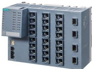
SCALANCE XCH328 managed switch IE di Layer 2, 24x RJ45 da 10/100/1000 Mbit/s, 4x porte 1/10 Gbit/s SFP+, LED per diagnostica, contatto di segnalazione errore con tasto Select/Set, PROFINET IO Device, Network Management, funzioni di ridondanza, Office Features (RSTP, VLAN, IGMP,...) CLP nella dotazione di fornitura montaggio: guida DIN/profilata S7 Conformal Coating
