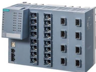
SCALANCE XCM324 managed Switch IE di Layer 2, 16x RJ45 da 10/100/1000 Mbit/s, 8x porte 1/10 Gbit/s SFP+, LED per diagnostica, contatto di segnalazione errore con pulsante Select/Set, PROFINET IO Device, Network Management, funzioni di ridondanza, Office Features (RSTP, VLAN, IGMP,...) CLP nella dotazione di fornitura montaggio: guida DIN/profilata S7 .
