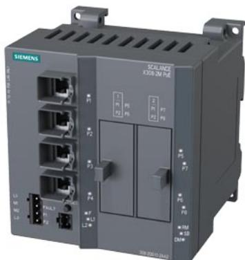
SCALANCE X308-2M PoE; managed IE Switch, compatto; 4x 10/100/1000 Mbit/s per porte RJ45 elettriche con PoE; 2x 100/1000 Mbit/s per media module a 2 porte, elettriche oppure ottiche; diagnostica LED, contatto di segnalazione contatto con pulsante Select/Set, PROFINET IO Device, Network management, integrato manager di ridondanza, Office Features (RSTP, VLAN, IGMP,..) C-PLUG nella dotazione di fornitura.
