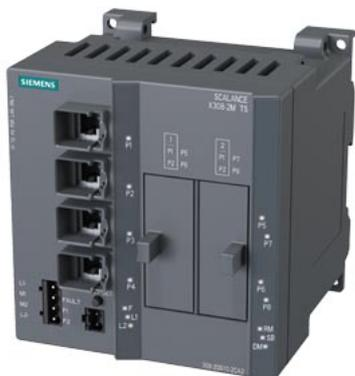
SCALANCE X308-2M TS; managed IE Switch, compatto; 4x 10/100/1000 Mbit/s per porte RJ45 elettriche; 2x 100/1000 Mbit/s per media module a 2 porte, elettriche oppure ottiche; diagnostica LED; contatto di segnalazione; PROFINET IO Device; Network Management; manager di ridondanza integrato; Office Features (RSTP, VLAN, IGMP,...); C-PLUG nella dotazione di fornitura, esteso campo di temperatura, con certificazione ferroviaria EN 50155.
