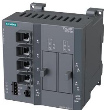
SCALANCE X308-2M; managed IE Switch, compatto; 4x 10/100/1000 Mbit/s per porte RJ45 elettriche; 2x 100/1000 Mbit/s per media module a 2 porte, elettriche oppure ottiche; diagnostica LED; contatto di segnalazione; pulsante Select/Set; PROFINET IO Device; Network management; integrato manager di ridondanza; Office Features (RSTP, VLAN, IGMP,..); C-PLUG nella dotazione di fornitura.
