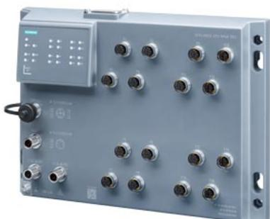
SCALANCE XP216PoE EEC, managed IE Switch, con omologazione ferroviaria certificato IEC 62443-4-2; (EN 50155, EN45545); 12x porte M12 da 10/100 Mbit/s, 4x porte M12 da 10/100/1000 Mbit/s IP65, diagnostica LED, contatto di segnalazione errore, alimentazione di tensione ridondante, PROFINET IO Device, Network Management, funzionante nell'anello ridondante, incl. cappucci di protezione antipolvere, incl. manuale elettr. su CD-ROM, C-PLUG opzionale.
