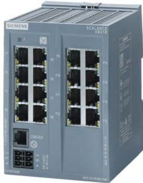
SCALANCE XB216 manageable Switch IE di Layer 2, 16X porte RJ45 da 10/100 Mbit/s, 1x porta di console, LED di diagnostica rosso alimentazione di tensione ridondante; certificato IEC 62443-4-2; campo di temp. 0 °C ... +60 °C montaggio su guida profilata; EtherNet/IP predefinito.
