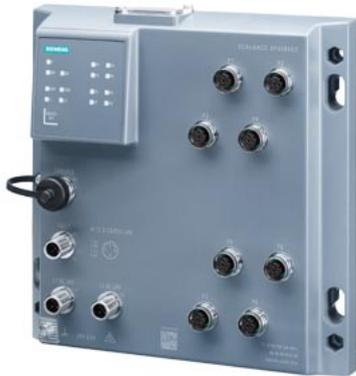
SCALANCE XP208PoE EEC, managed IE Switch, 8x porte 10/100 Mbit/s certificato IEC 62443-4-2; porte M12, IP65, diagnostica LED, contatto di segnalazione errore, alimentazione di tensione ridondante, PROFINET IO Device, Network Management, funzionante nell'anello ridondante, cappucci di protezione antipolvere, incl. manuale elettr. su CD-ROM, C-PLUG opzionale.
