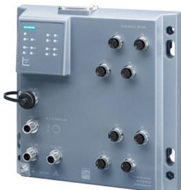
SCALANCE XP208, managed IE Switch, 8x porte 10/100 Mbit/s porte M12, IP65, diagnostica LED, contatto di segnalazione errore, alimentazione di tensione ridondante, certificato IEC 62443-4-2 PROFINET IO Device, Network Management, funzionante nell'anello ridondante, cappucci di protezione antipolvere, incl. manuale elettr. su CD-ROM, C-PLUG opzionale.
