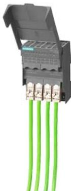
SCALANCE XF208, piatto, switch IE managed, 8x porte RJ45 da 10/100 Mbit/s, contatto di segnalazione errore con pulsante Set, alimentazione di tensione ridondante ; PROFINET IO Device, Network Management, manager di ridondanza integrato, incl. manuale elettronico su CD-ROM, C-PLUG opzionale.
