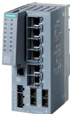
SCALANCE XC206-2 manageable IE Switch di Layer 2; certificato IEC 62443-4-2; 6x porte RJ45 da 10/100 Mbit/s; 2x porte SC da 100 Mbit/s; 1x porta di console; LED di diagnostica; alimentazione di tensione ridondante; campo di temp.-40 °C...+70 °C; montaggio: su guida DIN/profilata S7/a parete; funzioni di ridondanza; Office Features (RSTP, VLAN,...); PROFINET IO Device conforme a Ethernet/IP slot C-PLUG.
