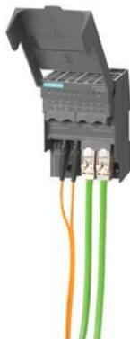
SCALANCE XF206-1, piatto, switch IE managed, 6x porte RJ45 da 10/100 Mbit/s, 1x porta FO da 100 Mbit/s, contatto di segnalazione errore con pulsante Set, alimentazione di tensione ridondante ; PROFINET IO Device, Network Management, manager di ridondanza integrato, incl. manuale elettronico su CD-ROM, C-PLUG opzionale.
