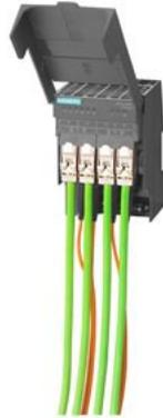
SCALANCE XF204-2, piatto, switch IE managed, 4x porte RJ45 da 10/100 Mbit/s, 2x porte FO da 100 Mbit/s, contatto di segnalazione errore con pulsante Set, alimentazione di tensione ridondante ; PROFINET IO Device, Network Management, manager di ridondanza integrato, incl. manuale elettronico su CD-ROM, C-PLUG opzionale.
