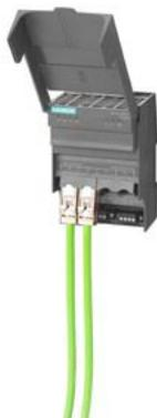
SCALANCE XF204, piatto, switch IE managed, 4x porte RJ45 da 10/100 Mbit/s, contatto di segnalazione errore con pulsante Set, alimentazione di tensione ridondante ; PROFINET IO Device Network Management, manager di ridondanza integrato, incl. manuale elettronico su CD-ROM, C-PLUG opzionale.
