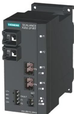
SCALANCE X202-2P IRT managed IE IRT Switch, 2x 10/100 Mbit/s porte RJ45, 2x 100 Mbit/s porte SC RJ per POF, contatto di segnalazione errore con pulsante Set, alimentazione di tensione ridondante, PROFINET IO Device, Network Management, manager di ridondanza integrato, incl. manuale elettronico su CD-ROM, C-PLUG opzionale
