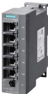
SCALANCE X005EEC, IE Entry Level switch unmanaged 5x porte RJ45 da 10/100 Mbit/s, diagnostica LED, IP30, DC 24 V alimentazione di tensione, collare di ritenzione conforme a PROFINET, campo di temperatura ampliato -40 °C ..... +75 °C, omologazione E1 manuale disponibile come download .
