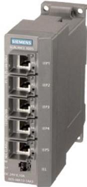
SCALANCE X005, IE Entry Level Switch unmanaged 5 x 10/100 Mbit/s, porte RJ45, diagnostica LED, IP30, DC 24 V alimentazione di tensione, collare di ritenzione conforme a PROFINET, campo di temperatura ampliato -40 °C ..... +75 °C, manuale disponibile come download .
