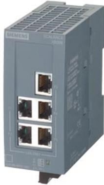
SCALANCE XB005 unmanaged Industrial Ethernet Switch per 10/100 Mbit/s; per la configurazione di piccole strutture a stella e strutture lineari; diagnostica LED, IP20, AC/DC 24V alimentazione di tensione, con 5x 10/100 Mbit/s Twisted Pair Ports con prese RJ45; manuale disponibile come download .
