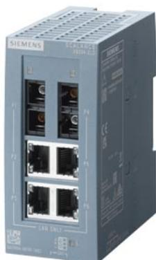
SCALANCE XB004-2LD unmanaged Industrial Ethernet Switch per 10/100 Mbit/s; per la configurazione di piccole strutture a stella e strutture lineari; diagnostica LED, IP20, AC/DC 24V alimentazione di tensione, con 4x 10/100 Mbit/s Twisted Pair Ports con prese RJ45; 2 x Single-Mode in vetro da 100 Mbit/s porta a fibre ottiche con presa SC; manuale disponibile come download .
