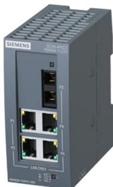
SCALANCE XB004-1LDG unmanaged Industrial Ethernet Switch per 10/100/1000 Mbit/s; per la configurazione di piccole strutture a stella e strutture lineari; diagnostica LED, IP20, DC 24 V alimentazione di tensione, con 4x porte RJ45 da 10/100/1000 Mbit/s elettriche e 1x porta SC da 1000 Mbit/s porta SC ottica (singlemode, vetro), fino a max. 10 km manuale disponibile come download .
