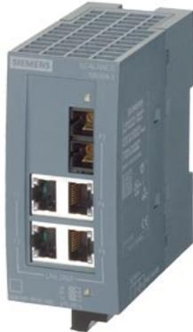
SCALANCE XB004-1 unmanaged Industrial Ethernet Switch per 10/100 Mbit/s; per la configurazione di piccole strutture a stella e strutture lineari; diagnostica LED, IP20, AC/DC 24V alimentazione di tensione, con 4x 10/100 Mbit/s Twisted Pair Ports con prese RJ45; 1 x 100 Mbit/s Multimode porta a fibre ottiche con presa SC; manuale disponibile come download .
