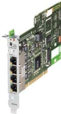
processore di comunicazione CP scheda PCI 1616 (32 bit; 33/66 MHz; 3,3/5V) con ASIC ERTEC 400 per il collegamento a PROFINET IO con switch a 4 porte real time (RJ45) tramite kit di sviluppo DK-16XX PN IO; NCM PC.
