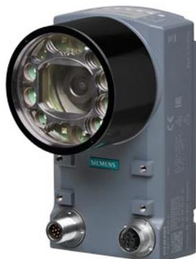
lettore ottico SIMATIC MV530 H risoluzione: 1280 x 1024 pixel; funzione: lettura di codici 1D/2D; campo di lavoro [mm]: 30...250, in base alle dimensioni del DOT; campo visivo[mm]: 40x30...320x255; PoE; IP67; fornitura: lettore completo incl. illuminatore ad anello da incasso VERDE, filtro polarizzato, ottica 5,6 mm (fuoco fisso fuoco, copertura fissa) e tubo di protezione;
