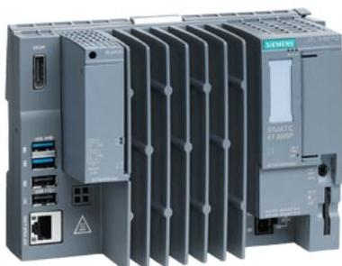
SIMATIC ET 200SP Open Controller, CPU 1515SP PC2, 8 GB RAM (apparecchiatura di base 6ES76772DB400AA0), 128 GB CFast con Windows 10 IoT Enterprise 64 bit e S7-1500 Software Controller CPU 1505SP preinstallato, interfacce: 1x slot CFAST, 1x slot SD/MMC, 1x collegamento per ET 200SP BusAdapter PROFINET, 1x 10/100/1000 MBit/s Ethernet, 2x USB 3.0; 2x USB 2.0, 1x DisplayPort, documentazione su CFast, Restore-Image su CFast
