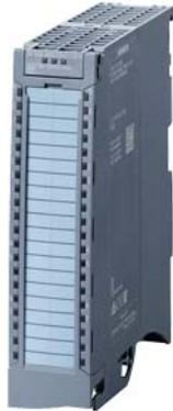
SIMATIC S7-1500, modulo di uscite digitali DQ16x24..48VUC/125V DC/0,5A ST; 16 canali in gruppi di 1; 0,5A per ogni gruppo; valore sostitutivo: osservare il derating l'unità supporta la disinserzione in sicurezza dei gruppi di carico fino a SIL2 secondo EN IEC 62061:2021 e categoria 3 / PL d secondo EN ISO 13849-1:2015. connettore frontale (morsetti a vite oppure push-in) da ordinare separatamente
