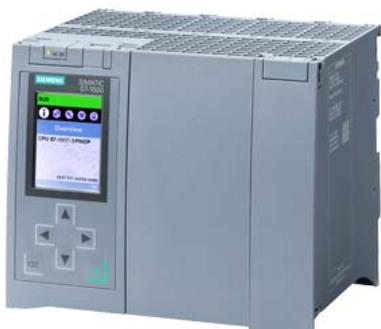
SIMATIC S7-1500, CPU 1517-3 PN/DP, unità centrale con memoria di lavoro 2MByte per il programma e 8MByte per i dati, 1ª interfaccia: PROFINET IRT con switch a 2 porte, 2ª interfaccia: PROFINET RT, 3ª interfaccia: PROFIBUS, performance a bit di 2 ns, SIMATIC Memory Card necessaria
