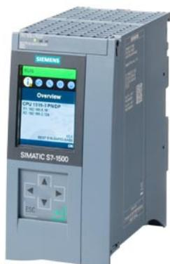
SIMATIC S7-1500, CPU 1516-3 PN/DP, unità centrale con memoria di lavoro 2 MB per il programma e 7,5 MB per i dati 1<sup>a</sup> interfaccia: PROFINET IRT con switch a 2 porte, 2<sup>a</sup> interfaccia: PROFINET RT, 3<sup>a</sup> interfaccia: PROFIBUS, performance a bit di 6 ns, necessaria SIMATIC Memory Card \*\*\* osservare omologazioni e certificati secondo articolo 109817466 su support.industry.siemens.com ! \*\*\*\*
