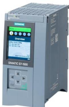
SIMATIC S7-1500, CPU 1515-2 PN, unità centrale con memoria di lavoro 1 MB per il programma e 4,5 MB per i dati, 1ª interfaccia: PROFINET IRT con switch a 2 porte, 2ª interfaccia: PROFINET RT, performance a bit di 6 ns, necessaria SIMATIC Memory Card \*\*\* osservare omologazioni e certificati secondo articolo 109817466 su support.industry.siemens.com ! \*\*\*\*
